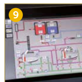
9 PLC PER LA GESTIONE AUTOMATICA DEL PROCESSO DI PRODUZIONE E LA MEMORIZZAZIONE DI RICETTE PLC PARA LA GESTIÓN AUTOMÁTICA DEL PROCESO DE PRODUCCIÓN Y LA MEMORIZACIÓN DE RECETAS
